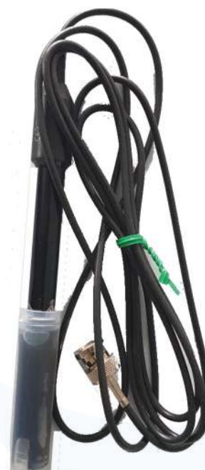
Sonde Redox avec pastille en Or sur la tête de mesure
