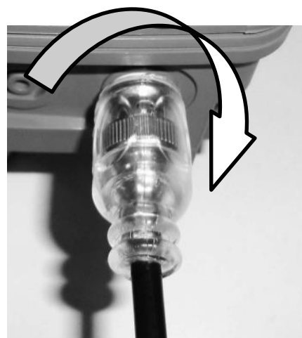
Tourner la fiche ¼ de tour pour fermer la connexion
