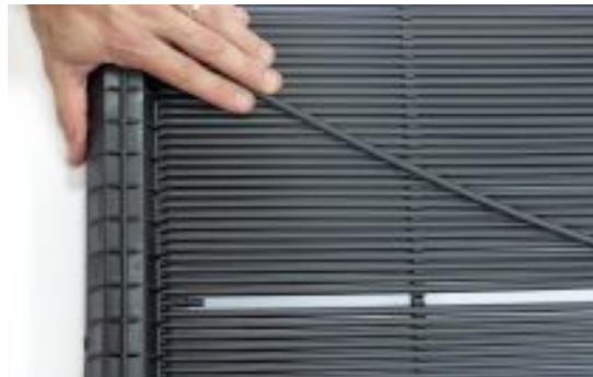
**5** Enfoncez le bouchon de réparation en plastique jusqu'au bout dans le manchon de réparation. Vous pouvez utiliser la partie arrière de la poignée pour l'enfoncer fermement dans le manchon. Le trou est maintenant bouché et ne fuira pas.
