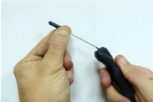
**2** Vaporisez le manchon en caoutchouc avec un lubrifiant en spray de silicone et tirez-le sur la petite broche métallique de la poignée de réparation.
