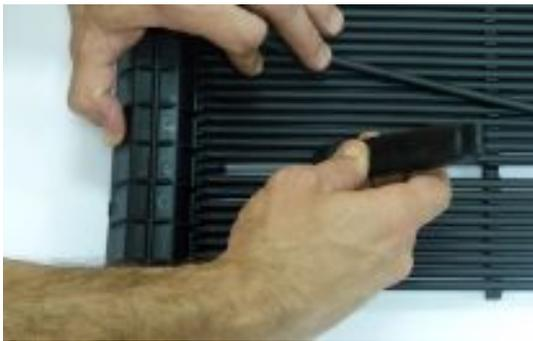
**3** Poussez doucement le manchon en caoutchouc dans le trou créé par le retrait du tube cassé, jusqu'à ce que seule la tête soit visible.
