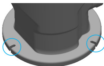
Figure 2 - Encoches de fixation au sol
