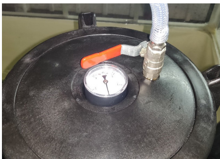
Figure 13 – Vanne quart de tour + tuyaux préconisés à la place de la vis de purge
