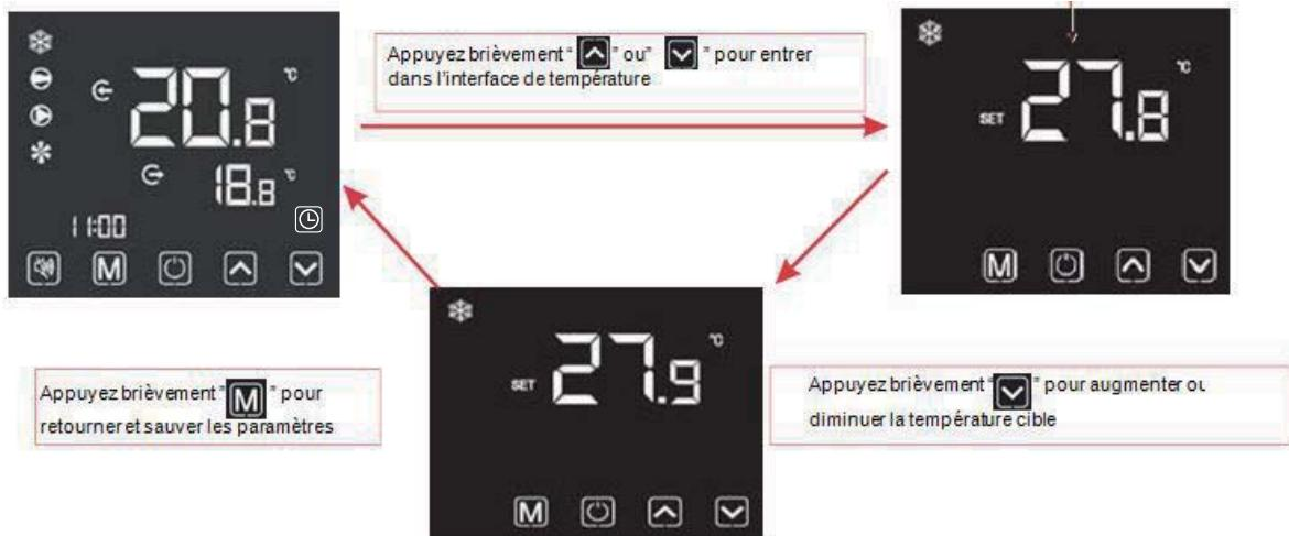
Notas: En la interfaz de regulación de la temperatura, si pulsa brevemente sobre el sistema volverá a la pantalla principal y no se grabará ninguna modificación. Cuando la temperatura de consigna seleccionada se presenta en la pantalla después de su actuación, espere 5 segundos para que se grabe la nueva temperatura de consigna presentada en la pantalla. El sistema memorizará automáticamente la regulación del usuario y volverá automáticamente a la interfaz principal.
