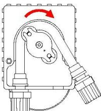
**F** Positionner le raccord de gauche du nouveau tube péristaltique dans l'encoche prévue à cet effet. Faire attention à ce que la partie arrondie soit orientée vers l'intérieur. Tourner le porte-galet dans le sens horaire de façon à ce que le tube péristaltique se mette naturellement en place. Ne jamais tourner à contre-sens.
