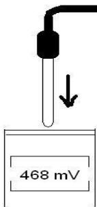
**IT** Inserire la sonda di Rx nella soluzione tampone a 468mV. Attendere qualche secondo la stabilizzazione della lettura.
