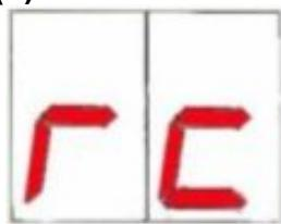
**IT** Se alla fine della calibrazione il display mostrerà la scritta "rc", premere il tasto CAL per uscire dalla calibrazione e tornare in lettura. Ripetere la procedura di calibrazione e se dopo il secondo tentativo comparirà ancora la scritta "rc", cambiare la sonda che non è in buona salute e va sostituita.
