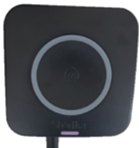
Coffret Connect avec le câble d'alimentation 230 VAC
