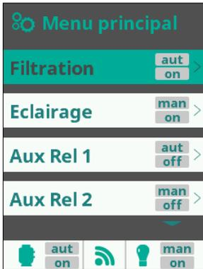
Le menu « Filtration » permet de régler la commande de la pompe de filtration. Il permet aussi de régler la commande du chauffage.
