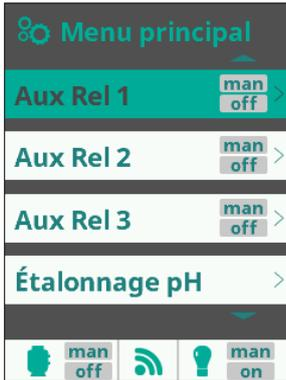
Le Salt Relax POWER permet la gestion de 4 fonctions (par exemple jeux aquatiques, nage à contre-courant, cascade, éclairage de jardin). Ces fonctions sont connectées aux relais auxiliaires qui peuvent aller jusqu'à 4. La description qui suit concernant le relais auxiliaire 1 s'applique aussi aux autres relais.
