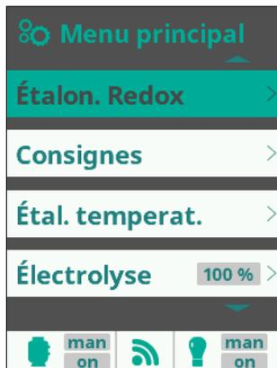
Pour procéder au réglage de l'étalonnage Redox, sélectionner « Etalon. Redox » avec / puis confirmer avec .
