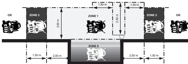
Čerpadlo je určené k čerpaniu úžitkovej vody s teplotou do 35°C ako súčasť bazénových filtračných jednotiek. Čerpadlo nezakrývajte a neinštalujte do vlhkého alebo do zle vetraného priestoru, pretože motor čerpadla je chladený voľne cirkulujúcim vzduchom. Neinštalujte čerpadlo v miestach kde môže dôjsť k zaplaveniu čerpadla vodou. Chráňte čerpadlo pred nepriaznivými poveternostnými vplyvmi a priamym slnečným žiareniom.
