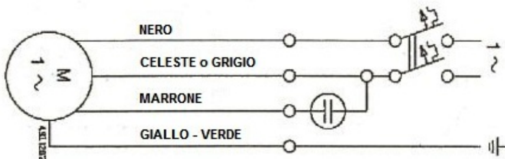
Schema di Collegamento Motori Monofasi
