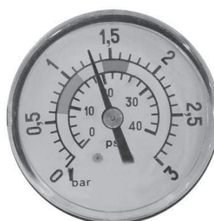
1,3 kg/cm 2 - 18,5 PSI: Cette pression indique qu'il est nécessaire de procéder à un LAVAGE.
